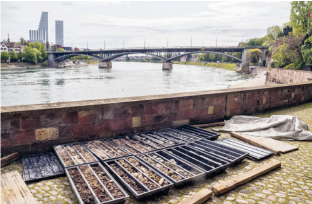
ABB. 7 Die Bohrkern, die auf der Pfalz entnommen wurden, bestätigen, dass das Gelände hier über Jahrhunderte aufgeschüttet wurde. Foto: Sven Billo.
