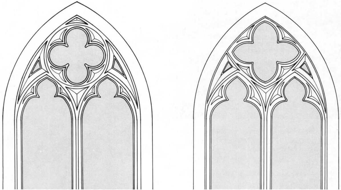
Abb. 28. Rekonstruktionszeichnung der Fenster-Masswerke im Chor der Deutschritterkapelle. Links: Fenster 8i/g/l; rechts: Fenster 8f/h/k/m. Zum Rhythmus vgl. Abb. 27. – Rekonstruktion und Entwurf: Z. Breu; Umzeichnung: H. Eichin. – Massstab 1:20.
