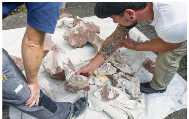
**ABB. 23** Ramon Keller von der Münsterbauhütte begutachtet die Sandstein-spolien aus dem Fundament im Hof des Petersschulhauses, die von einem oder mehreren gotischen Masswerkkfenstern stammen. Foto: Philippe Saurbeck.
