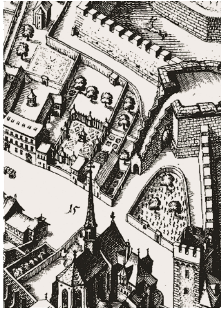
ABB. 27 Über eine Rampe konnten auf das in den Stadtgraben hineinreichende Bollwerk Geschütze gezogen werden. So war es möglich, vom turmartigen Bau aus weite Teile der Mauer und des Vorfelds zu schützen. Grosser Vogelschauplan «Basel von Norden» von M. Merian d. Ä.
