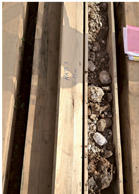
ABB. 50 Die Sedimente der Rammkernbohrungen werden zur Begutachtung nach Höhenbereichen getrennt in Holzkisten aufbewahrt. Foto: Norbert Spichtig.
