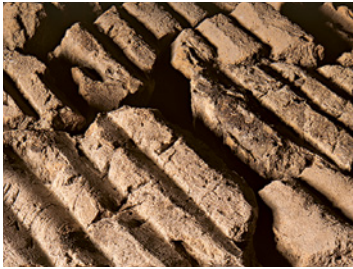
ABB. 11 Wandlehmrest einer römischen Fachwerkwand mit Rutenabdrücken, gefunden bei Ausgrabungen auf dem Basler Münsterhügel. Foto: Philippe Saurbeck.
