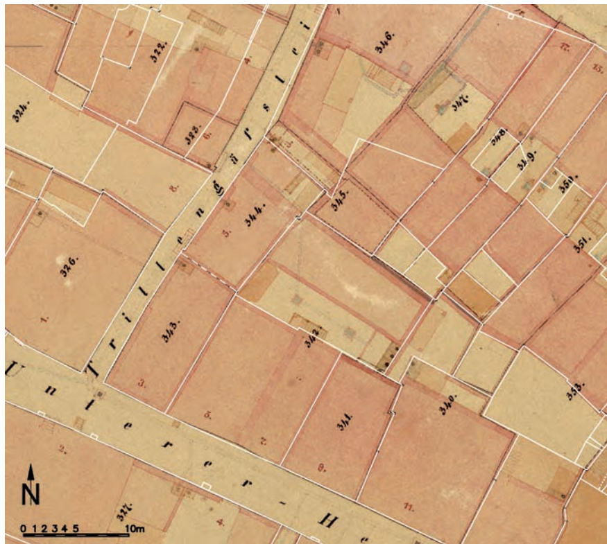
Abb. 6 Unterer Heuberg 7. Situation um 1860, in weissen Linien der aktuelle Kataster eingeblendet. Die Liegenschaft Unterer Heuberg 7 setzt sich aus den beiden Hausteilen Nr. 5 und 7 zusammen. Rückseitig das breite, sich bis über die Parzelle von Nr. 9 erstreckende Hinterhaus, das 1968 abgebrochen wurde. – Grundbuchplan von Rudolf Falkner (Ausschnitt), aquarellierte Federzeichnung, 1863–1872, GVABS.
