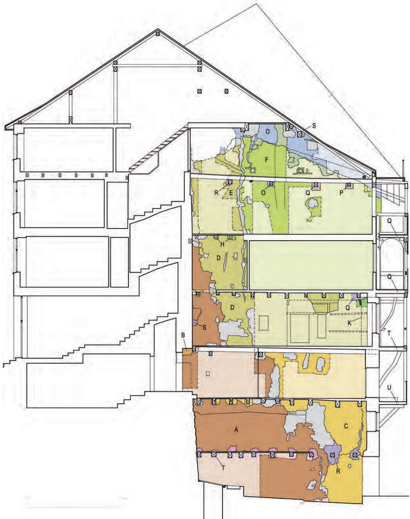
Abb. 6 Blumenrain 28. Freilegungen an der nördlichen, rheinabwärts gewandten Brandmauer. A: Ruine der mittelalterlichen Uferbefestigung (mit horizontalem Absatz im 2. UG). B: Einflickung Rundbogentür durch die Uferbefestigung. C: rheinseitiger Baukörper von 1335. D: Ersatz/Erhöhung rheinseitiger Baukörper von 1363. E: Hochgezogene Brandmauer von 1363. F: Hochgezogene Brandmauer von Haus Blumenrain 30. H: Bodenbalken 2. OG von 1432. K: Täfelstube von 1436. O: Aufstockung und neues Dachwerk von 1587. P: Unterzug zu Dachbalken (mit dargestelltem Grauband) und Zwischenboden im Dach von 1606. Q: Unterzug zu Dachbalken (mit dargestelltem Grauband) und Anbau Lauben von 1647. R: Unterzug zu Dachbalken und Bodenbalken 2. UG von 1675. S: Dachwerk von 1779. T: Bodenbalken 2. UG und Laube EG von 1831. U: Laube 1. UG aus dem 19. Jh. Zeitlich nicht bestimmte Einflickungen sind grau eingefärbt. Nicht freigelegte Bereiche sind in ergänzendem Sinn in einem der dort jeweils vermuteten Bauphase angenäherten, helleren Ton eingefärbt. – Zeichnung: Conradin Badrutt, Daniel Huber, Bernard Jaggi, Matthias Merki, Stephan Tramèr. Bearbeitung: Conradin Badrutt, Jan Borner, Martin Chramosta, Daniel Huber, Philipp Ryffel.
