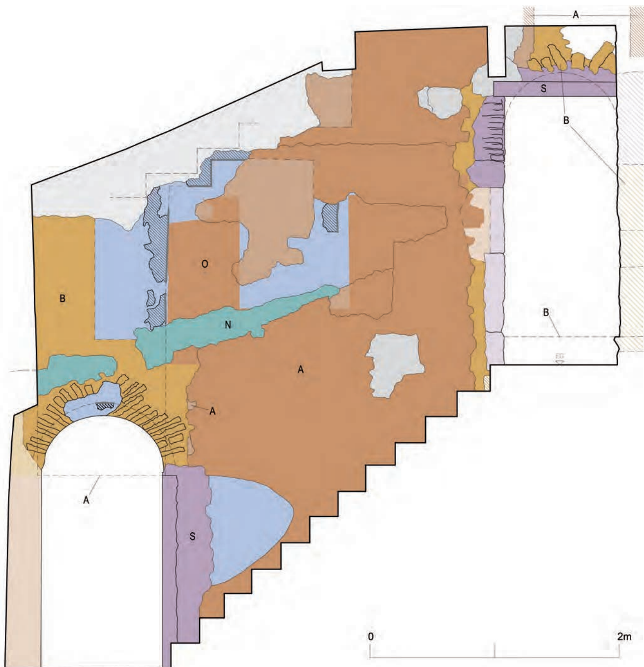
Abb. 14 Blumenrain 28. Freilegungen an der Binnenmauer (strassenseitiger Hausabschnitt, 1. UG bis EG). A: Mittelalterliche Uferbefestigung (mit horizontaler Arbeitsfuge, originalen Putzresten und verputzten Leibungen A). B: Einflickung der zwei Rundbogentüren. N: Einflickung Kellerhals-Gewölbe. O: Putzflächen von 1587 mit rotem Begleitband zu einer alten Haustreppe. S: Einflickungen von 1779. Schwelle und Leibungen der im Uferbefestigungswerk original angelegten Öffnungen A sind gestrichelt markiert (siehe Kapitel 3.1), ebenso Schwelle und Rundbogen des eingeflickten Durchgangs B im EG (siehe Kapitel 3.2) und die rekonstruierte Untersicht der Treppe (siehe Kapitel 3.16). – Zeichnung: Hans Ritzmann. Bearbeitung: Jan Borner, Philipp Ryffel.
