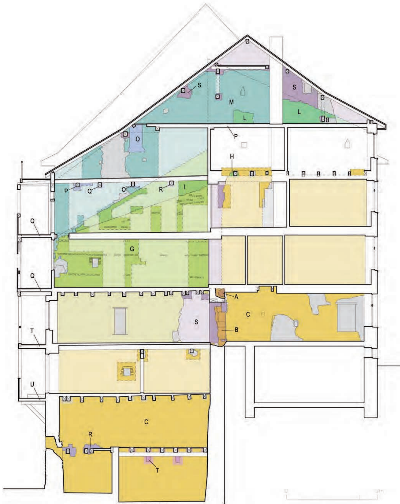
Abb. 17 Blumenrain 28. Freilegungen an der südlichen, rheinaufwärts gewandten Brandmauer. A: Originale Öffnungsleibung in der mittelalterlichen Uferbefestigung. B: Einflickung Rundbogentür in der Uferbefestigung. C: strassen- und rheinseitiger Baukörper von 1335. G: hochgezogene Giebelmauer. H: Bodenbalken 3. OG von 1432. I: Abänderung Giebelmauer mit stärkerer Dachneigung. L: strassenseitige Giebelmauer. M: Giebelmauer Blumenrain 26 von 1555. O: Aufstockung und neues Dachwerk von 1587. P: Unterzug zu Dachbalken und Zwischenboden im Dach von 1606. Q: Unterzug zu Dachbalken und Anbau Lauben von 1647. R: Unterzug zu Dachbalken und Bodenbalken 2. UG von 1675. S: Einflickungen Binnenmauer und Dachwerk von 1779. T: Bodenbalken 2. UG und Laube EG von 1831. U: Laube 1. UG aus dem 19. Jh. Zeitlich nicht bestimmte Einflickungen sind grau eingefärbt. – Zeichnung: Daniel Huber, Bernard Jaggi. Bearbeitung: Jan Borner, Martin Chramosta, Daniel Huber, Philipp Ryffel.
