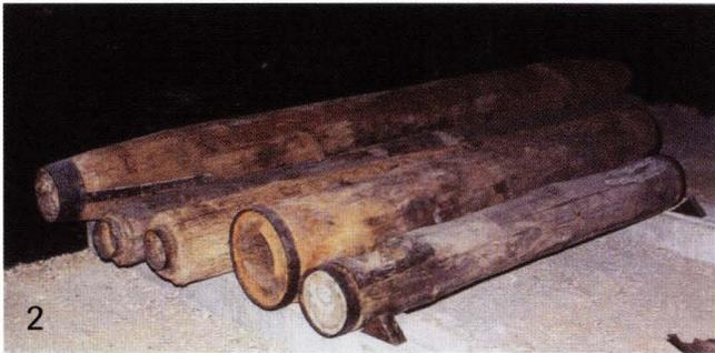
**Abb. 38** Teuchel im Museum Heidenheim (D). 1: Teuchel Typ 1 mit Muffenverbindung. 2: Teuchel Typ 2 mit endständigem Metallreif (und Muffenverbindung). – Bild aus: *Die Wasserversorgung in der Renaissancezeit. Geschichte der Wasserversorgung Bd. 5*, Verlag Philipp von Zabern, Mainz am Rhein 2000, S. 104.
