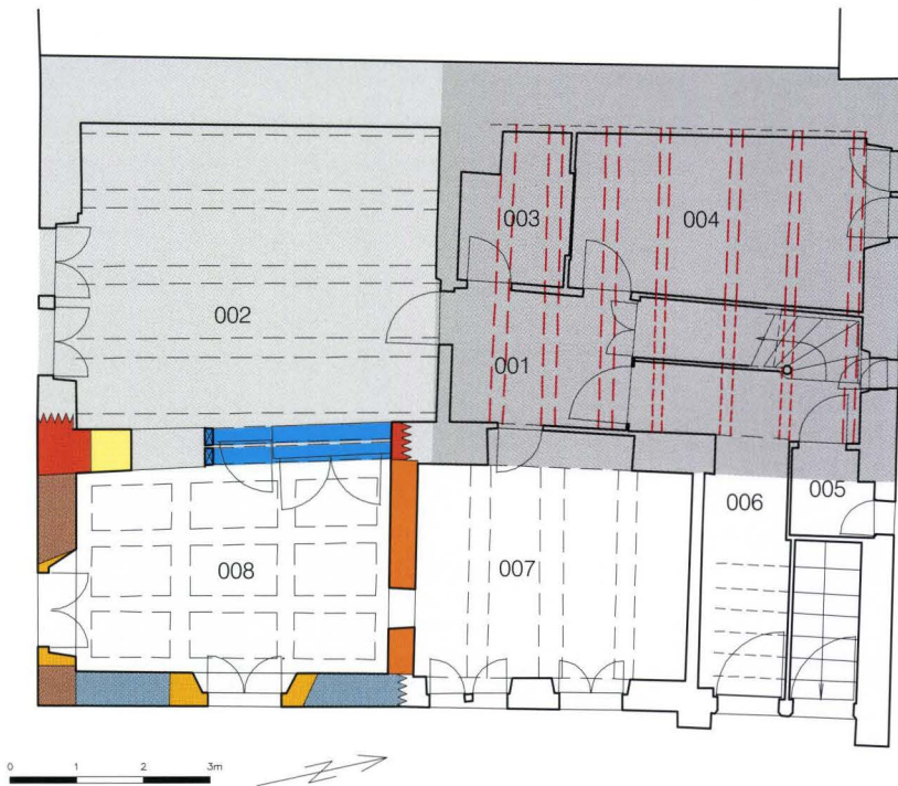
Abb. 10-17 Rössligasse 7, Riehen (2003/381). EG-Grundriss mit eingezeichneten Bauphasen. Oben die ältere, westliche Haushälfte von 1609, unten die Erweiterung von 1707. In der hinteren westlichen Hälfte (001, 003, 004) die Balken des Ursprungs-Gebäudes von 1406. Unten links das untersuchte Eckzimmer mit den farblich hervorgehobenen Mauerphasen. – Aufnahme: Hans Ritzmann. Bearbeitung: Conradin Badrutt.
