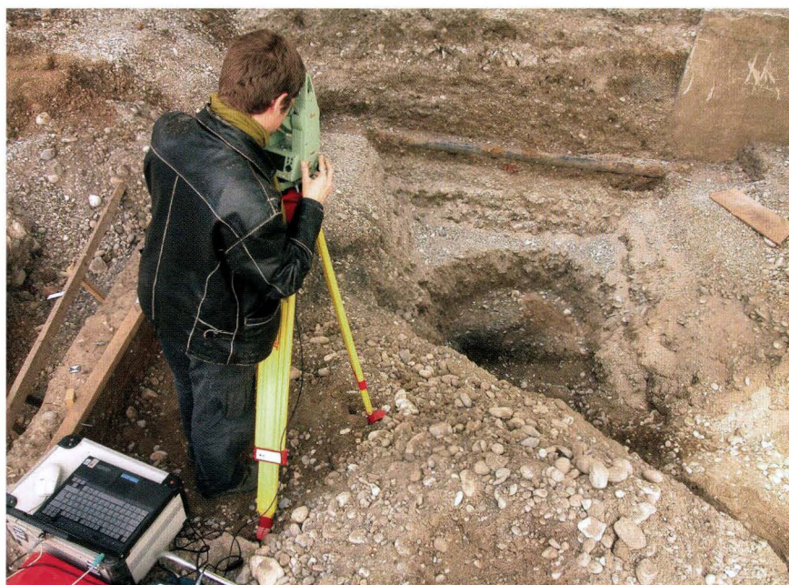
Abb. 7 Grabung 2003/5. CAD-Zeichner mit Notebook und reflektorlosem elektronischem Tachymeter bei der digitalen Dokumentation von Grube 435. – Foto: Sophie Stelzle-Hüglin.
