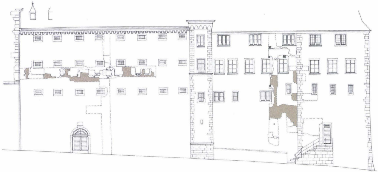
Abb. 9 Lohnhof. Fassade am Kohlenberg mit eingetragenen Befunden zur Inneren Stadtmauer. – Massstab 1:100. – Zeichnung: Hans Ritzmann nach Vorlagen von Andreas Macke und Christian Lenz.
