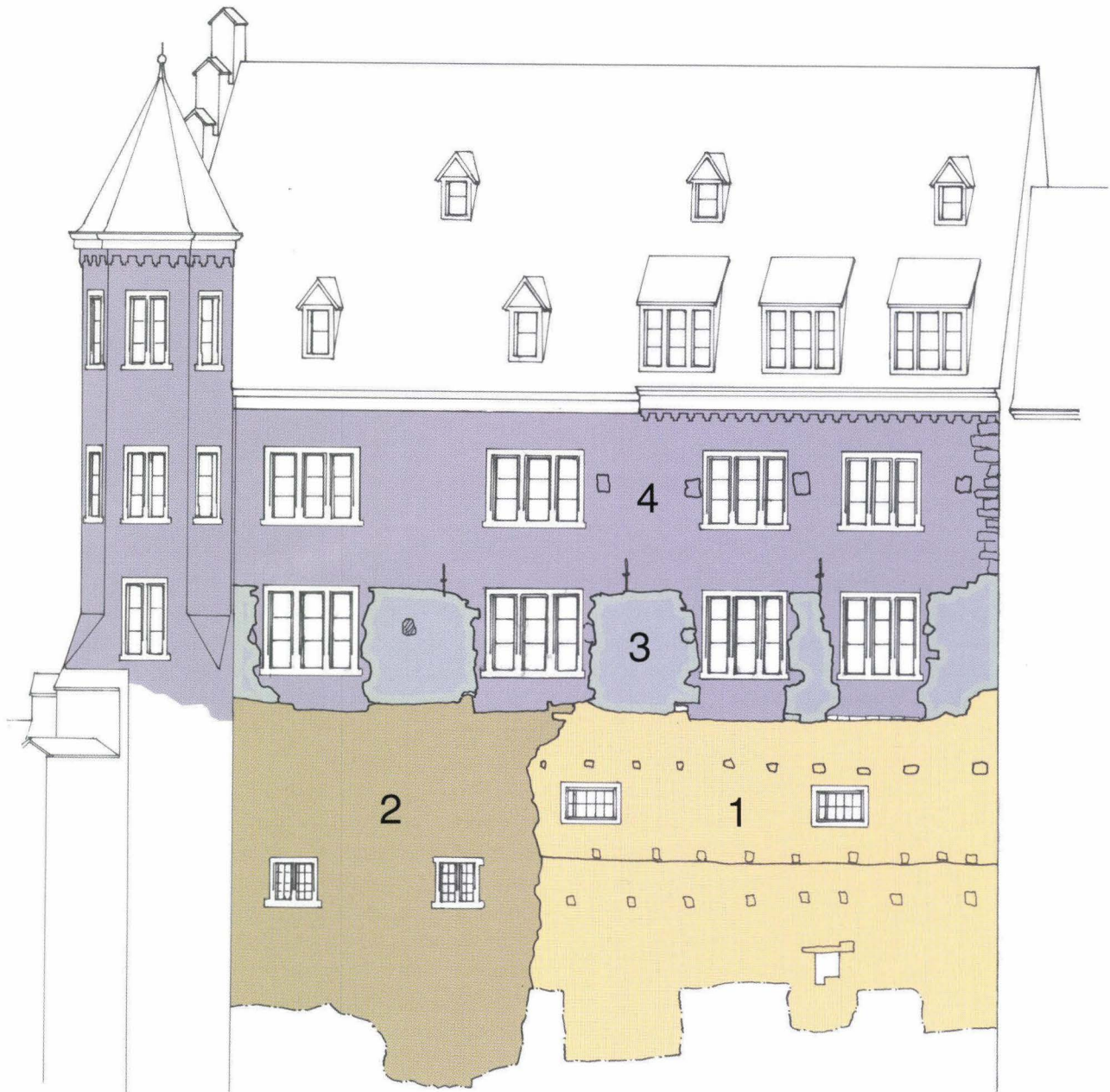
Abb. 41 Lohnhof. Ansicht der Ostfassade des Hüglin-von-Schönegg-Hauses mit Eintrag der Bauphasen. – Massstab 1:100. – Zeichnung: Christian Lenz. Bearbeitung: Hans Ritzmann.
