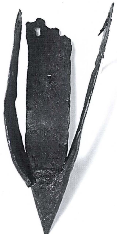
Abb. 51 St. Jakobs-Strasse 395–397 – Stadion St. Jakob (1999/4). Eiserner Pfahlschuh eines Rammpfahles des Steges von 1338/39 (FK 28524). – Foto: Philippe Saurbeck.
