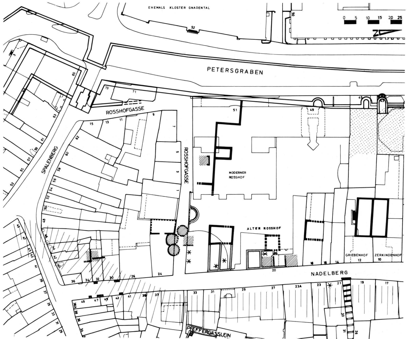
Abb. 5. Basel – Niederterrasse, Spalenberg/Nadelberg/Petersgraben (Abb. 1,4a). Holzbauten des 12./13. Jh. (schraffiert), gewerblich genutzte Höfe mit Feuer- und Herdstellen (Sternsignaturen), Kernbauten des 13. Jh. (schwarz umrandet) sowie Anbauten des 14. Jh. (hell schraffiert). Unmittelbar östlich des Nadelbergs verläuft die Kante des Talhangs. – Zeichnung: Ch. Bing. – Massstab 1:1000.
