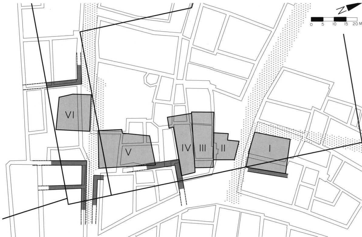
Abb. 2. Basel – untere Talstadt, Petersberg (Abb. 1,2a): Kontinuität der Gassen (nachgewiesene hochmittelalterliche Gassen: Punktraster) und Gebäudegrenzen der hochmittelalterlichen Holzbauten I–VI (Grundriss gerastert), der frühen Steinbauten (Mauerverlauf dunkel gerastert) sowie der nach deren Abbruch angelegten spätmittelalterlich-frühneuzeitlichen Überbauung (feine, nicht ausgefüllte Linien). Die moderne Überbauung ist durch einfache schwarze Linien eingezeichnet. Grundlage: Katasterplan des 19. Jh. (Falknerplan, aufgenommen 1868–70); Berger 1963, Plan II. – Zeichnung: Ch. Bing. – Massstab 1:1000.
