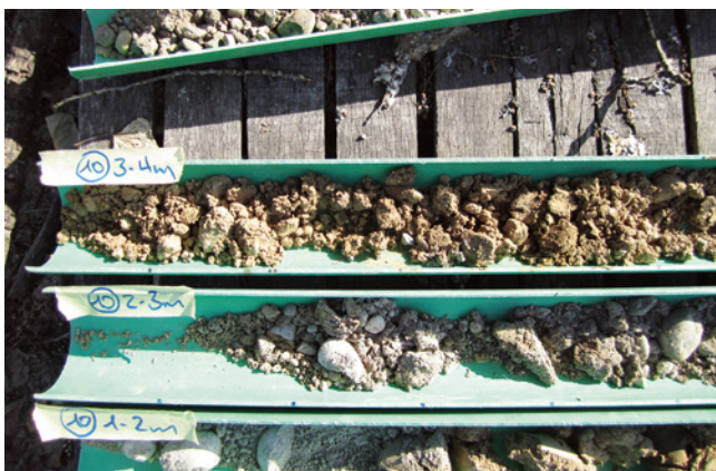
ABB. 42 Die Sedimentabfolgen aus einer Rammkernsondierung der Baugrundabklärung geben erste Aufschlüsse zur Erhaltung und zum Schichtaufbau. Foto: Norbert Spichtig.
