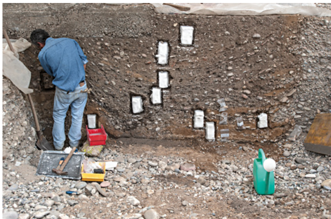
Abb. 59 Mikromorphologische Beprobung: wichtige Ausschnitte des Grubenprofils werden eingegipst entnommen. Die Blöcke werden später mit Epoxidharz getränkt und nach dem Aushärten in Scheiben gesägt. Daraus werden auch Dünnschliffe zum Betrachten unter dem Mikroskop hergestellt. Die Geoarchäologie nutzt diese Methode zur Analyse des Schichtaufbaus. Foto: Michael Wenk.
