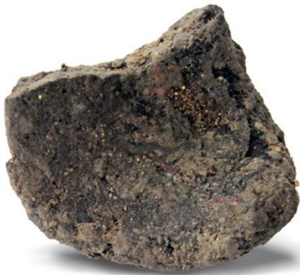
**Abb. 5** Das Fragment eines Gusstiegels mit anhaftenden Goldresten.
