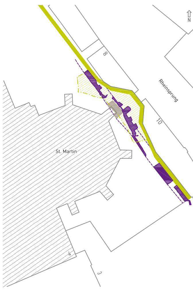
Abb. 13 Plan mit den bisher entdeckten Mauerfundamenten der älteren Stützmauer mit den vier Konsolsteinen. Massstab 1:250. Zeichnung: Christian Stegmüller.
