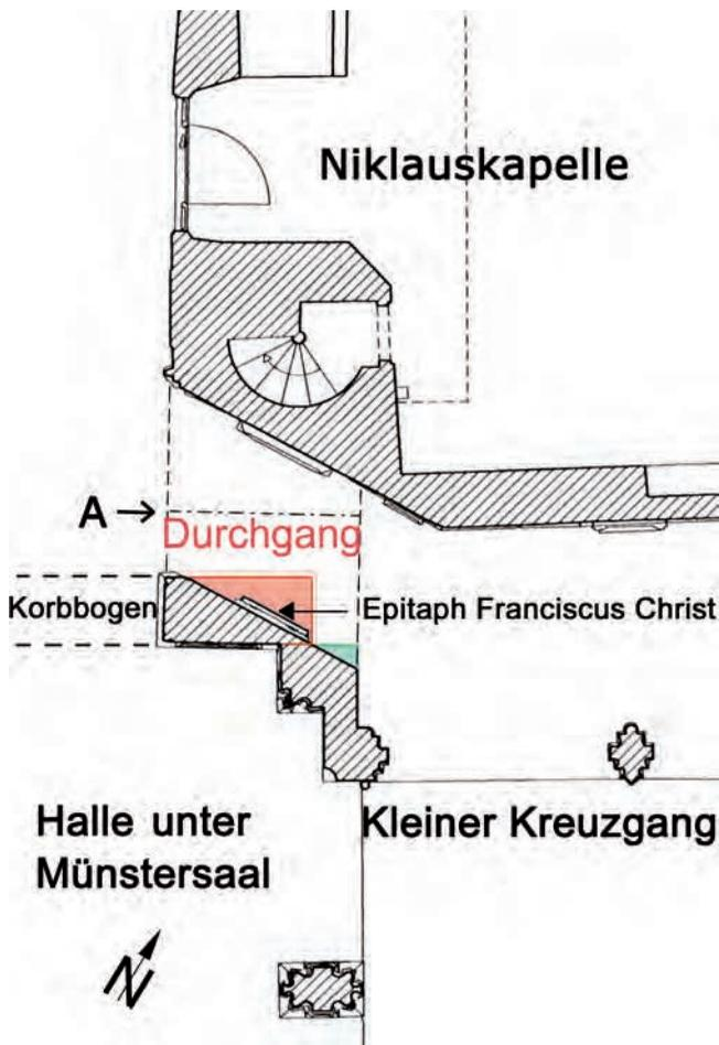
**Abb. 3** Münster. Durchgang von der Halle zum kleinen Kreuzgang. Hellrot: heute fehlender Teil des ursprünglichen Pfeilervolumens. Hellgrün: fehlender Teil des ursprünglichen Volumens des Pfeilers, der das Nordende der östlichen Arkaden unter dem Münstersaal bildet. A: Scheitelachse der Gewölbetonne. – Plan: Gesellschaft für Bildverarbeitung, Vermessung und Dokumentation, Müllheim (D). Bearbeitung: Matthias Merki.
