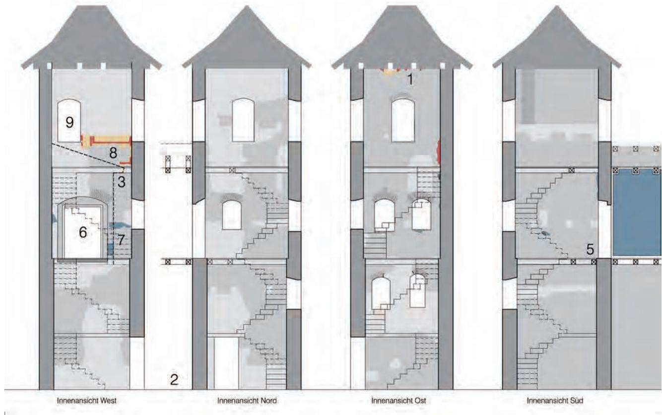
Das originale Bodenniveau (2) unmittelbar ausserhalb des Turms brachte die Grabung der Archäologischen Bodenforschung zutage. Es zeigte sich in einer Tiefe von 90 cm unter dem heutigen Hofniveau als Tonplattenboden, der zweifelsfrei als Gehniveau im Bereich um den Turm vor 1840 diente. Mit der massiven Auffüllung und Einebnung des hinteren Bereichs der Parzelle um 1840 wurde eine horizontale Durchfahrt (ohne Gefälle) von der Strasse in den Hof und zu den Stallungen geschaffen<sup>12</sup>.
