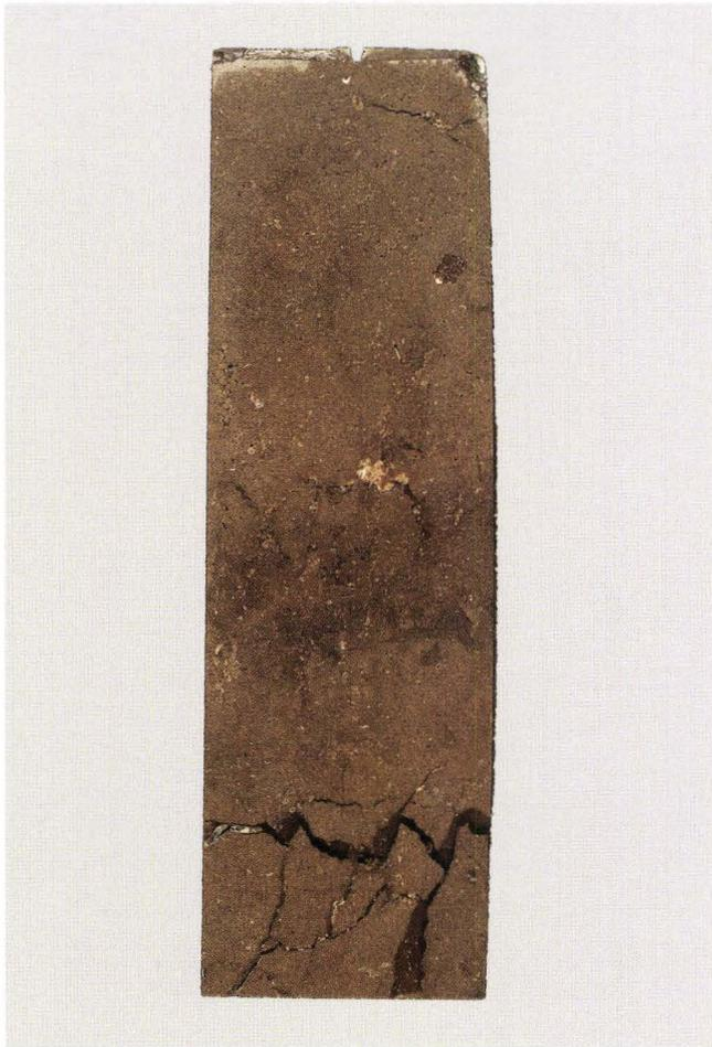
**Abb. 19** Riehen, Ludwig-Courvoisier-Strasse (1999/45). In Kunstharz eingegossene Bodenprobe M3 aus dem oberen Abschnitt der Lössdeckschichten von Profil P1. In der Bildmitte ist der humose Bodenhorizont (3) als dunkles Band deutlich erkennbar. Er trennt als interstadiale Bodenbildung (Denekamp?) die Lössdeckschichten 2 und 4. – Höhe des Anschliffes: 21 Zentimeter. – Foto: Philippe Saurbeck.
