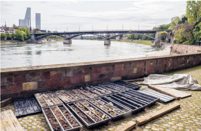
ABB. 7 Die Bohrkern, die auf der Pfalz entnommen wurden, bestätigen, dass das Gelände hier über Jahrhunderte aufgeschüttet wurde. Foto: Sven Billo.
